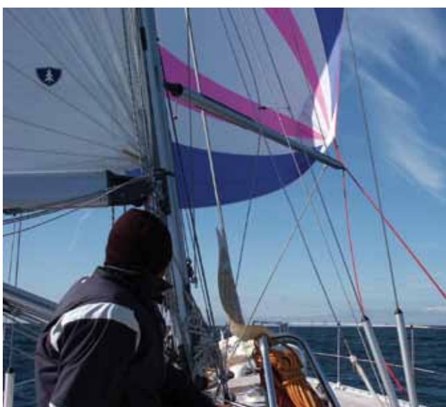
Spinnakerseiling med doble skjøter. Legg merke til at skjøtene går på utsiden av vantene og at nedhalet er strammet.
